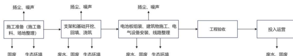
图 4.1-1 施工工艺流程和产排污节点图
