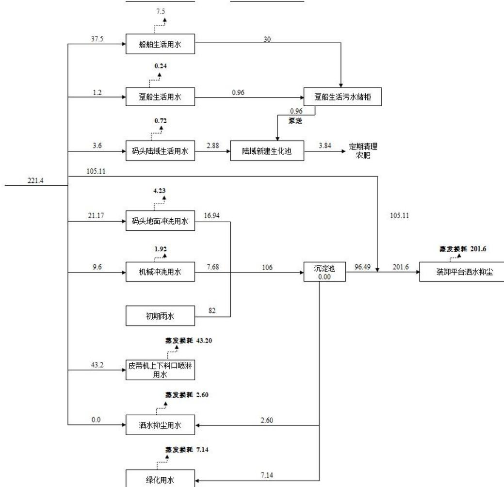
图 2.3-1 运营期项目水平衡图 (t/d)
